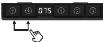
Um die Tischplatte anzuheben, betätigen Sie die Taste 1, zum Absenken der Tischplatte betätigen Sie die Taste 2.
